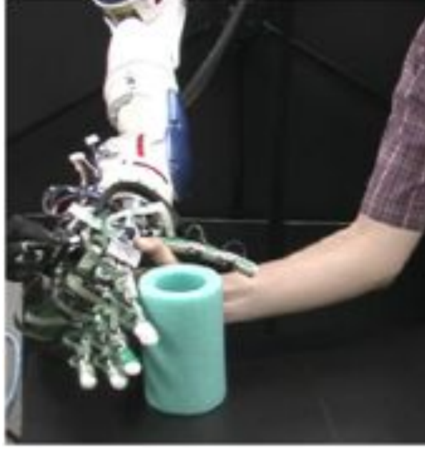
Şekil 15: Robotun kavrama davranışı, robotun kolu ile eli arasında yerleştirilmiş kuvvet/tork algıları kullanılarak, insan tarafından düzeltilir.
