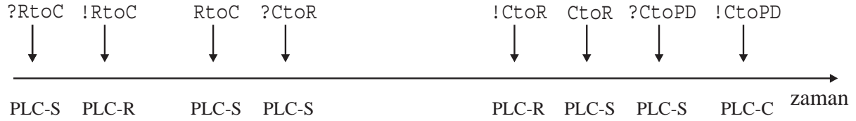
Şekil 26: Örnek için PLC haberleşmesi zamanlaması.
