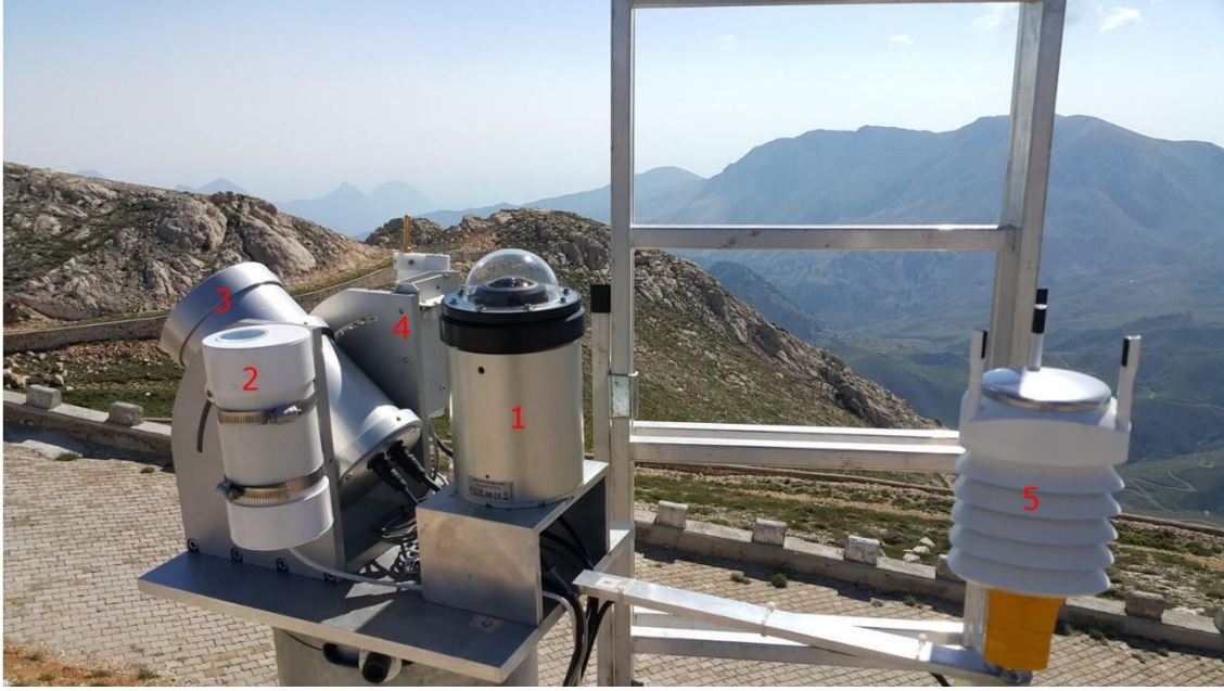
Şekil 2. GÖKSİS sisteminin temel ölçerleri. 1-ASC: Tüm Gökyüzü Kamerası, 2- SQM, 3-SM, 4-BW: Bulutluluk Ölçeri ve 5-Meteoroloji İstasyonu.
