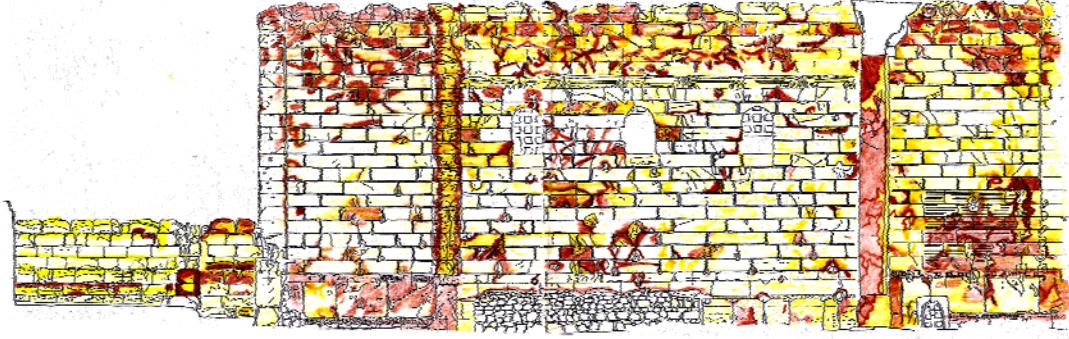
ŞEKİL 2. Latince harflerle yazılmış metnin bulunduğu güneydoğu duvarı sağ iç yüzeyinde malzeme ayrılmaları İNCE KABUKLANMALAR (1-2 mm) KALIN KABUKLANMALAR (1-3 cm) UFALANMALARLAR
