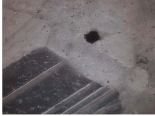
ŞEKİL 10. (a) Milas taş ocağından alınan taze mermer örneğinin (1.6 W ) ince kesit görüntüsü (çift nikol, 4X, fotoğrafın uzun kenarı 3.5mm'dir ). (b) 1.6 W örneğinden başka bir görünüm ve kapanım şeklinde gözlenen opak mineral (çift nikol, 40X, fotoğrafın uzun kenarı 0.35 mm'dir).
