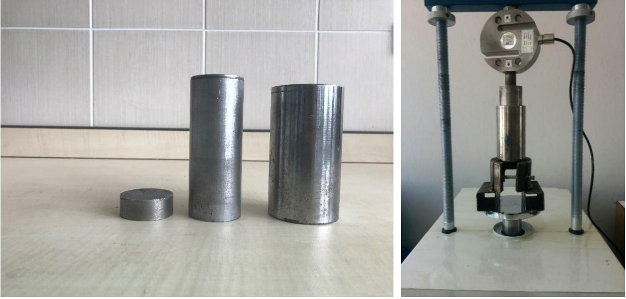
Şekil 5. Karışımların briketlenmesinde kullanılan çelik kalıp takımı
