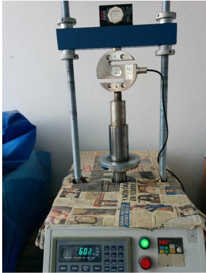
Şekil 6. Briketleme ve dayanım testlerinde kullanılan laboratuvar tipi kontrollü yük presi
