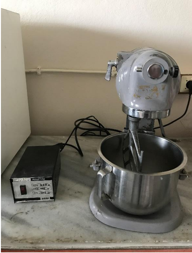
Şekil 4. Linyit-bağlayıcı-su karışımlarının homojenize edilmesinde kullanılan laboratuvar tipi karıştırıcı
