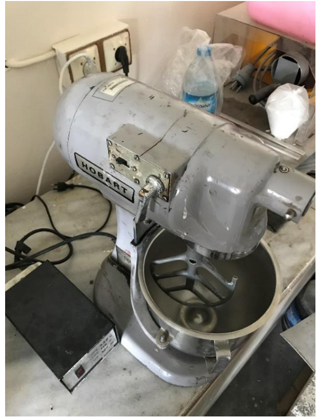
Şekil 4. Linyit-bağlayıcı-su karışımlarının homojenize edilmesinde kullanılan laboratuvar tipi karıştırıcı
