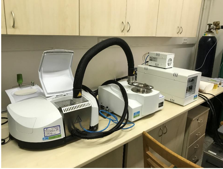
Şekil 3. TG/DTG, DSC analizleri için kullanılan termal analiz sistemi ve EGA analizleri için entegre gaz aktarım/FTIR ünitesi
