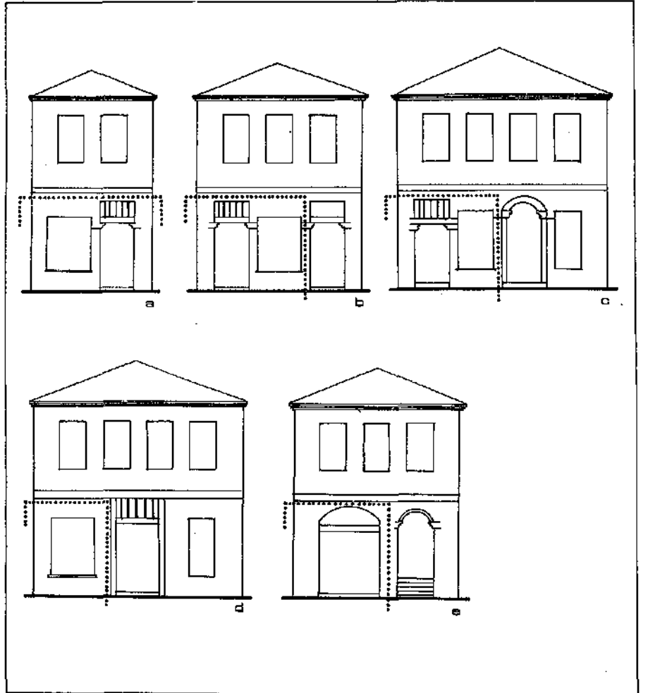
Şekil 12. Konut+Ticaret işlevlerinin birlikte olduğu yapılar. "a" tipi en yaygın örnektir. "b", "c" ve "d" tipleri de görülmektedir. "e" tipi ise ender kullanılan bir cephe düzenidir.
