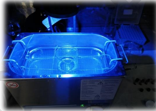
Şekil 1. Ultrasonik destekli fotokatalitik oksidasyon sistemi.
