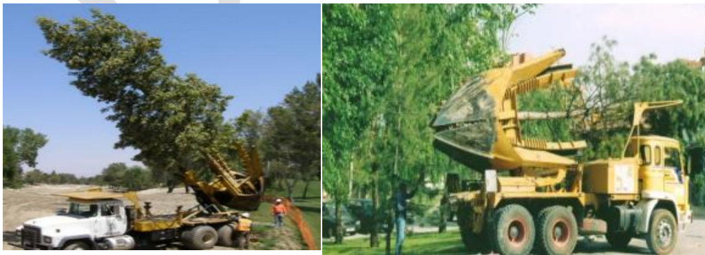
Şekil 3. Mekanik ağaç taşıyıcıları ile ağaç nakil işlemi (URL-2)
