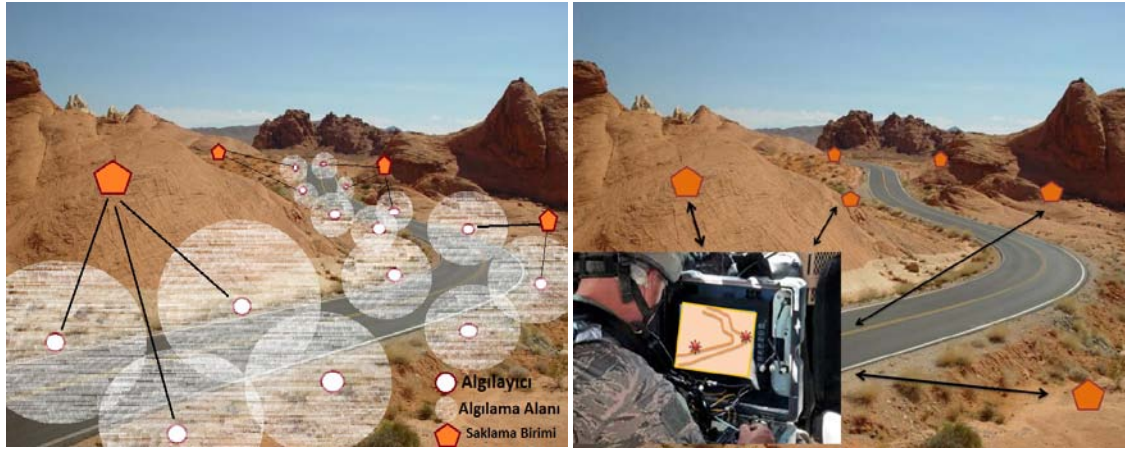
Şekil 1. Sensör ağı ile yolların gözetlenmesi: (Sol) Algılayıcı ve Saklayıcı birimler araziye gözlemler ve (Sağ) Saklayıcı birimler yaklaşan dost birliklere rapor verirler.
