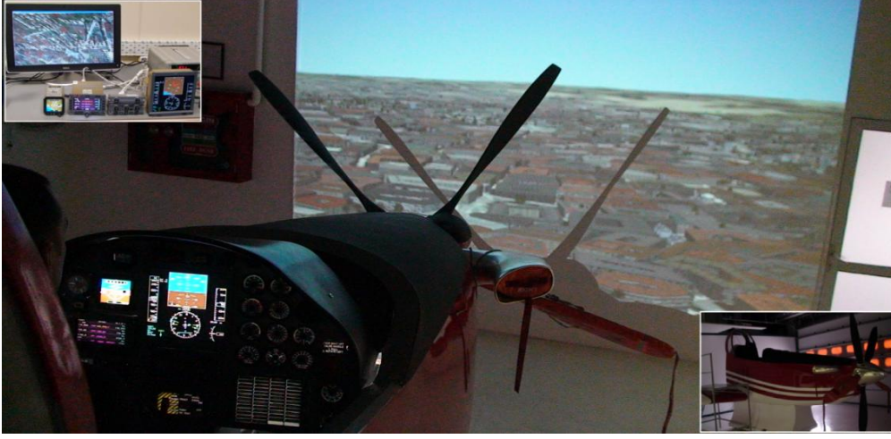
Şekil 7. RAHAT donanımının masa üzerinde (sol üst köşe) ve gövdeye entegre benzetimde çalışırken görüntüsü (büyük resim).
