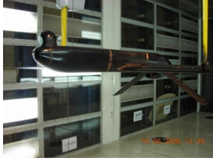
Şekil 4. ANKA rüzgâr tüneli ölçek modeli
