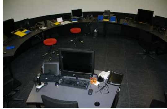
Şekil 3. AÜ-SHYO meydan kontrol simülâtörü çalışma pozisyonları
