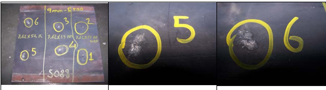
Şekil 7. Atış Sonrası Baz Zırhta Oluşan Deformasyon
