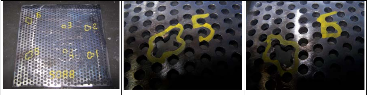
Şekil 6. Atış Sonrası Perfore Plakada Deformasyon
