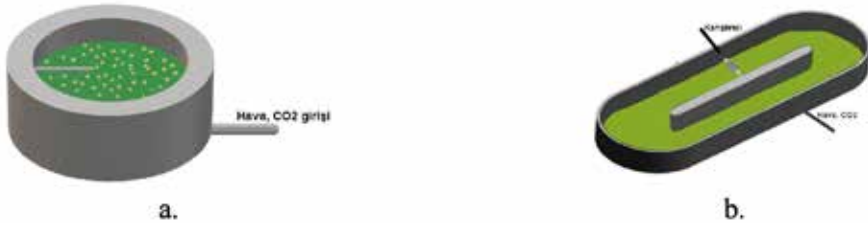
Şekil 2. Aerobik biyoreaktör türlerinin şematik gösterimi (a) Dairesel Havuz, (b) Karusel Tipi Biyolojik Havuz [15]
