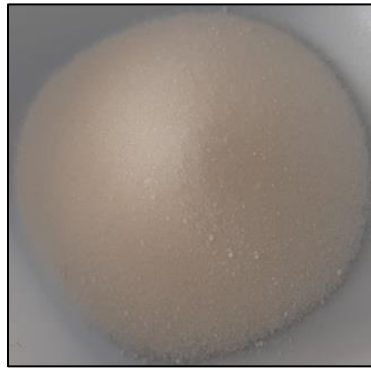
Şekil 1. Divinilbenzen-vinilpirilidon polimer esaslı adsorban malzeme
