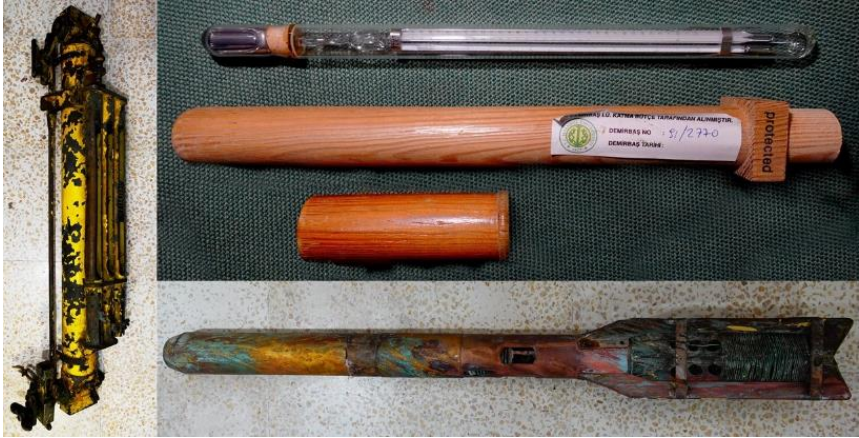
Şekil 2. Nansen şişesi, ters termometre ve BT (Gökçeada Deniz Canlıları Müzesi’nden)
