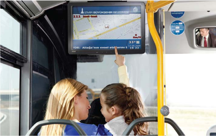
Resim 2. Araç İçi Yolcu Bilgilendirme Sistemi'ne ait bir fotoğraf < http://www.kentkart.com/UserFiles/tr_7fb8d541-7a19-4110-aa3b-319031c465fc.pdf >
