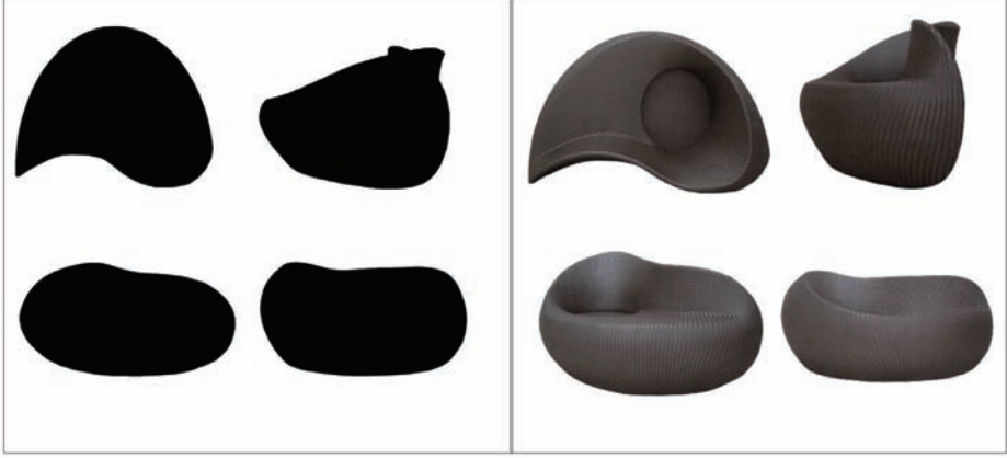
Resim 3. Görsel anlatımda ayrıntıları anlaşılmalı ve kabul edilmeyen görüşler (sol) ve aynı tasarımın düzeltilmiş görüşleri (sağ) (WIPO 2013)
