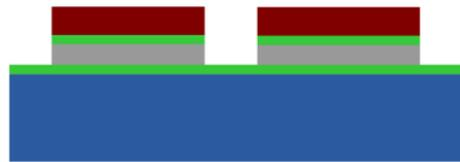
■ Si ■ Si<sub>x</sub>N<sub>y</sub> ■ NiCr ■ Photoresist
