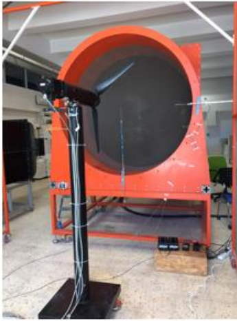
Şekil 6.Model rüzgâr türbininin küçük açık-jet test kesitindeki yerleşimi
